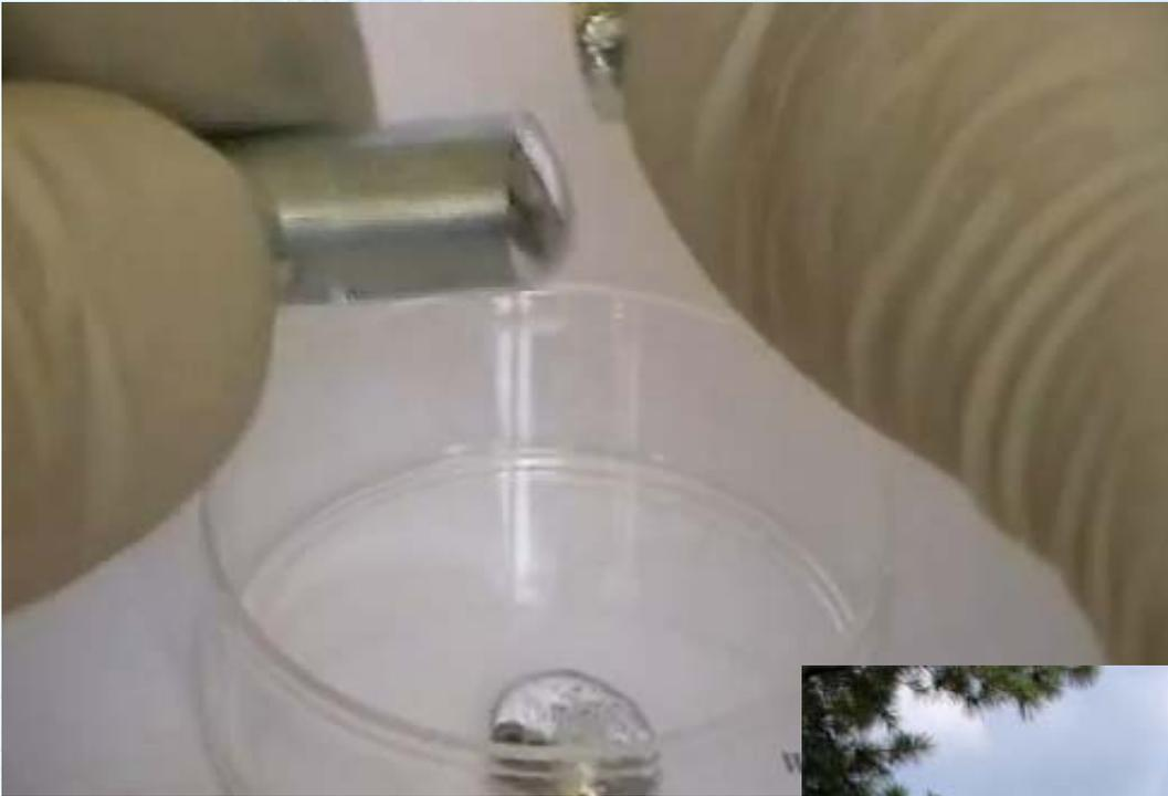
Эвтектика Na-K-Cs (Жидкий сплав)
