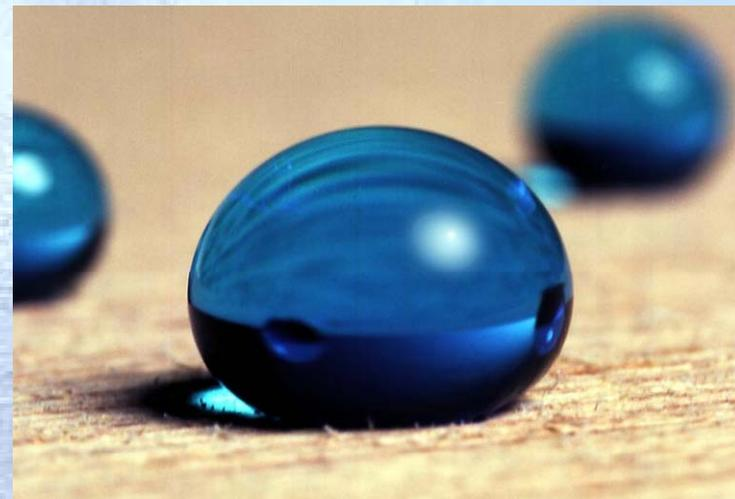
Капли воды на поверхности полимера с наноструктурированным покрытием
