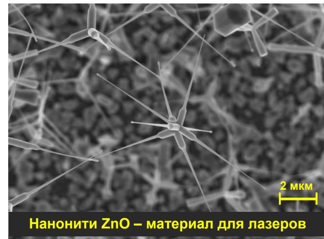
Нанонити ZnO – материал для лазеров
