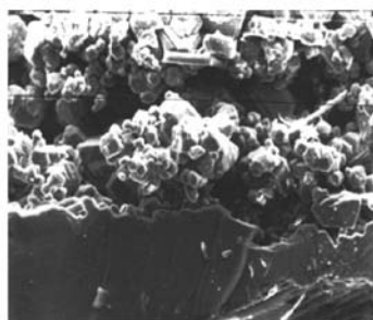
Рис. 4. Разработанные керамические карбидооксидные покрытия (для C-C композитов) с многоуровневой защитой от окисления
