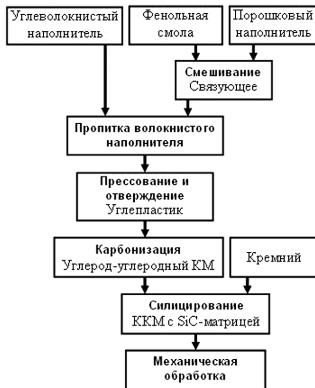
Рис. 1. Схема процесса получения ККМ с SiC матрицей методом силицирования карбонизированного углепластика
