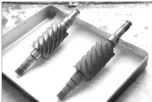
Рис. 3. Сравнение обработанного и необработанного шнека после работы в агрессивных средах
