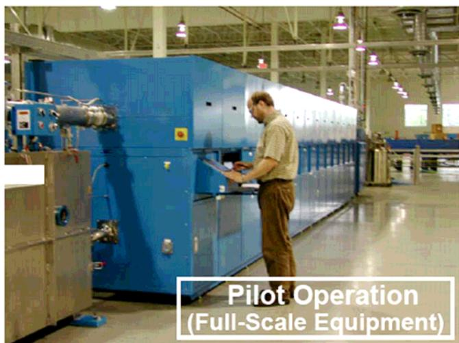
Рис. 1. Установка для производства ВТСП-ленты в American Superconductor.
