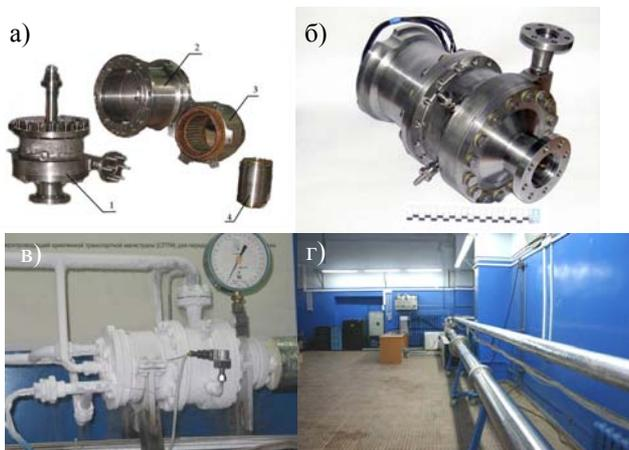
Рис. 6. Криогенный насос для ВТСП магистрали передачи электроэнергии. а) Крионасос с ВТСП электродвигателем (1 – корпус насоса, 2 – корпус двигателя, 3 – статор, 4 – ротор); б) Крионасос с ВТСП электродвигателем в сборе; в) ВТСП крионасос во время работы; г) Общий вид промышленного образца ВТСП магистрали передачи электроэнергии.
