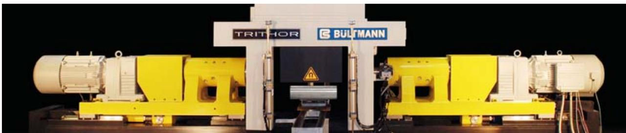
Рис. 2. ВТСП индукционный нагреватель Zenergy Power.
