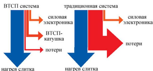
Рис. 3. Сопоставление ВТСП индукционного нагревателя с обычным.
