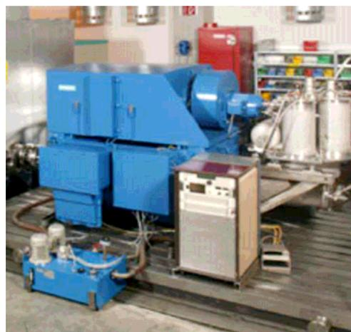
Рис. 2. Синхронный ВТСП генератор Siemens.
